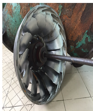
Thiết bị nhà máy thủy điện công suất 1,4 MW đã xuống cấp sau một thời gian vận hành.
