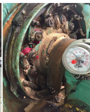
Thiết bị nhà máy thủy điện công suất 1,4 MW đã xuống cấp sau một thời gian vận hành.
